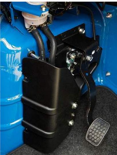
die neue 2 Kreis Bremsanlage, die nun hydraulische Bremskraft für vorne und hinten garantiert
